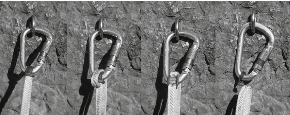
**Selbstsicherungsschlinge: Der Verschlusskarabiner wurde mit einem String in der Bandschlinge fixiert (links). Gelangt ein Strang der Bandschlinge z.B durch das Ein- und Aushängen aus der Materialschlaufe des Klettergurtes in den Karabiner, wird der Kletterer nur durch den Gummi des Strings «gesichert», der bereits bei geringen Kräften reisst - eine teuflische Gefahr.**
