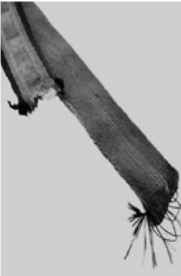
Die gerissene Bandschlinge ist ein 25 mm breites Schlauchband, welches als Meterware erhältlich war. Jeder eingewebte Kennfaden steht für 5 kN Zugfestigkeit, sodass die Schlinge am Einfachstrang einmal 15 kN ausgehalten haben muss.
